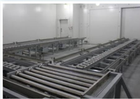
通过引进冷冻杀虫设备，实现了由溴化甲烷(会影响臭氧层)杀虫方式到环保的低温物理杀虫方式的转变。
